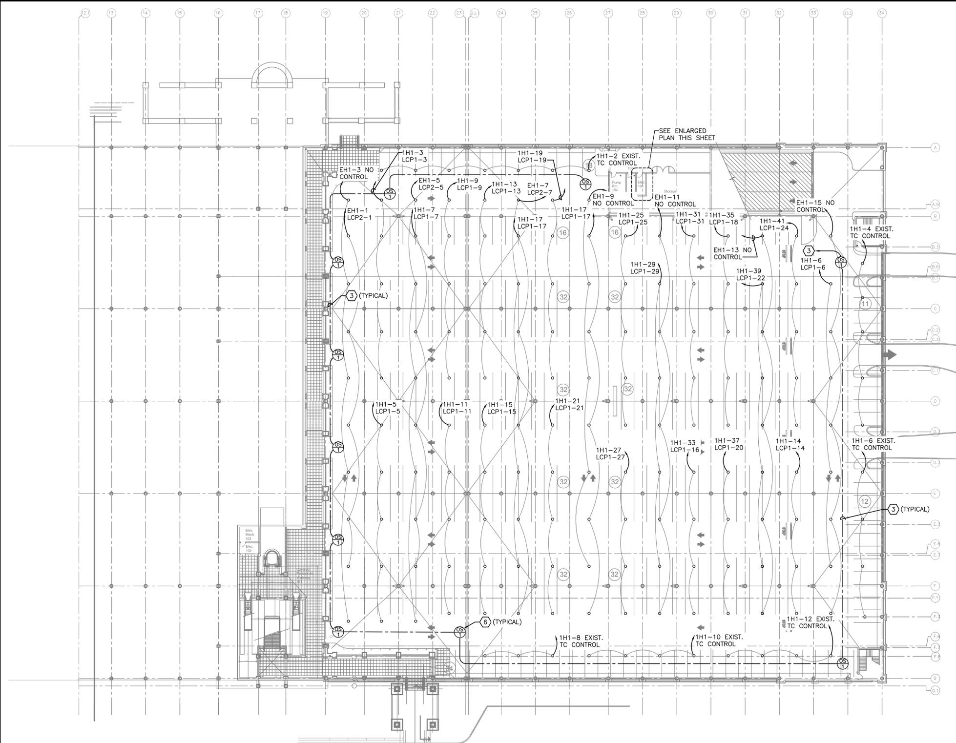
**ELECTRICAL LIGHTING CONTROL PLAN - GARAGE FIRST FLOOR**
